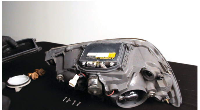
20) Remove the OEM ballast cover.
