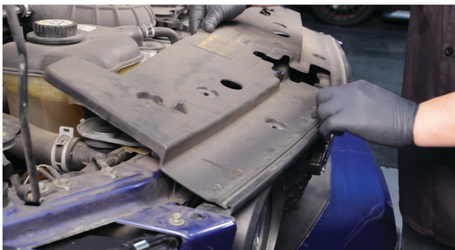
27) Reinstall filler panel.
